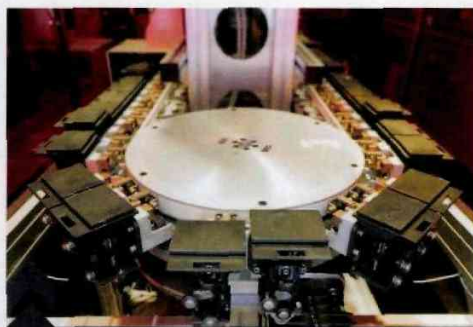
TNO a conçu une ligne pilote d'impression 3D qui peut produire 100 produits différents en quelques minutes.
